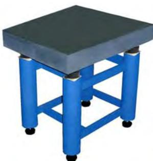
Auch Untergestelle mit integrierter Schwingungsdämpfung können wir liefern. Hierbei können verschiedene Schwingungsdämpfer eingesetzt werden. Gummierte Maschinenfüße dämpfen bis zu ca. 30Hz. Einfache Luftfederisolatoren dämpfen bis ca. 20 Hz. Hochwertige Luftfederisolatoren mit aktiver Niveauregelung sind die hochwertigste Art der Schwingungsisolierung. Hierbei können Schwingungen bis herunter auf ca. 10 Hz gedämpft werden.
