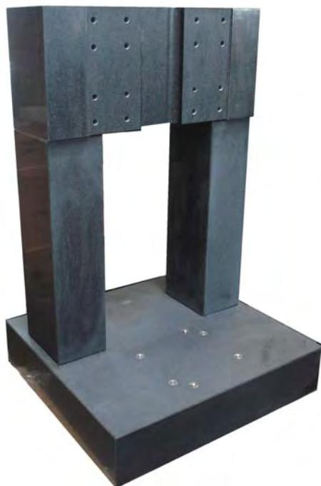
Granit kann man besonders genau bearbeiten. Bis unter 0,001 mm/m sind möglich. Die Oberflächengüte ist extrem gut. Dadurch lassen sich sehr genaue Führungen in Kombination mit Luftlagern realisieren. Aber auch als Basis für Kugelumlauf Führungen wird Granit häufig eingesetzt. Die Ausführung in Hartgestein lohnt sich besonders dann, wenn nur kleine Stückzahlen mit hoher Präzision gebraucht werden.
