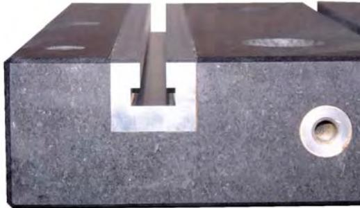
Bei den T-Nuten unterscheidet man eingeklebte Stahl-T-Nuten und direkt eingefräste T-Nuten. Die direkt eingefrästen T-Nuten haben eine geringere Belastbarkeit, da der Granit bei punktueller Last zum Ausbrechen neigt. Man kann aber die Last durch lange T-Nutensteine gleichmäßig auf die Nut verteilen, so daß ein punktuellies Ausbrechen der T-Nut vermieden wird.
