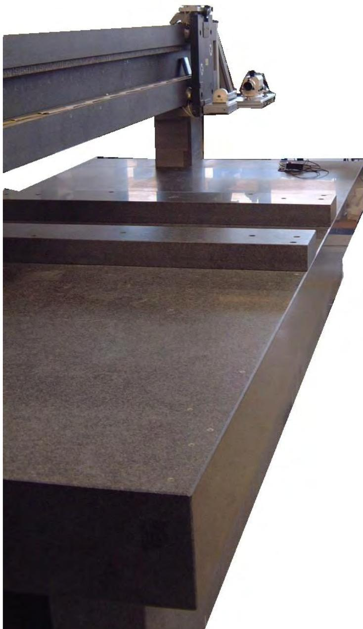
Granitbauteile können in sehr großen Abmessungen angefertigt werden. Aus einem Stück können Werkstücke bis zu 8 Meter Länge hergestellt werden. Darüber hinaus kann man Bauteile auch durch Kleben oder Verschrauben verbinden. Um Gewicht zu reduzieren ist eine Sandwichbauweise möglich.
